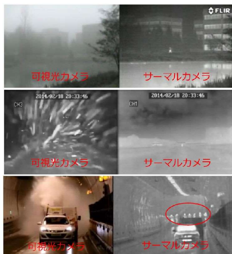
図-11 可視光カメラとサーマルカメラの映像例 (上：霧発生時、中：吹雪発生時、下：煙幕時)
