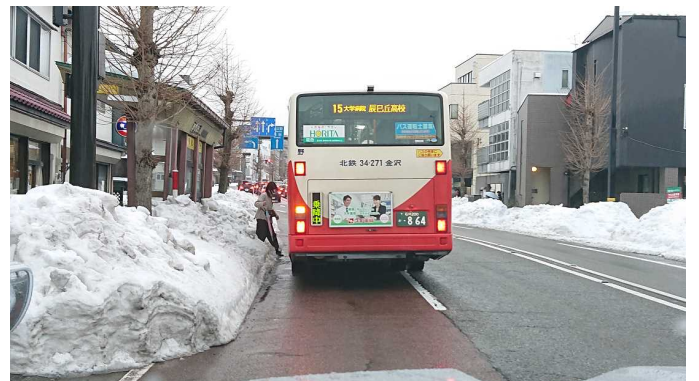
写真-4 消雪能力を超える降雪で塞がれるバス停
