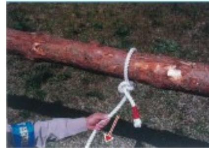
⑧ 仕上げの折に元ロープを引く時、結び目が緩みやすいので輪になったロープを左手親指で上から押さえながら、元ロープを素早く右手で引くのがコツである。
