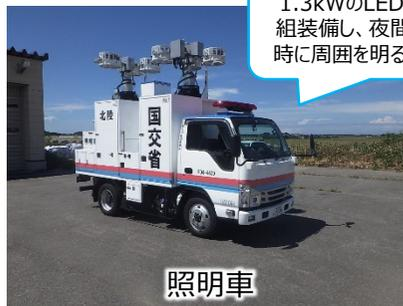
1.3kWのLED照明3灯を2組装備し、夜間の災害対応時に周囲を明るく照らします。
