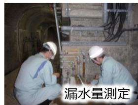
漏水量測定
