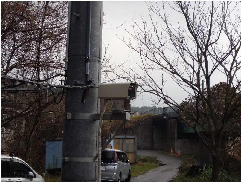
画像処理型水位計の設置イメージ
