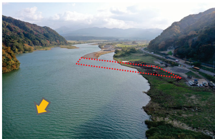
貝附地区(R7. 11撮影) 赤点線枠の箇所を掘削します。
