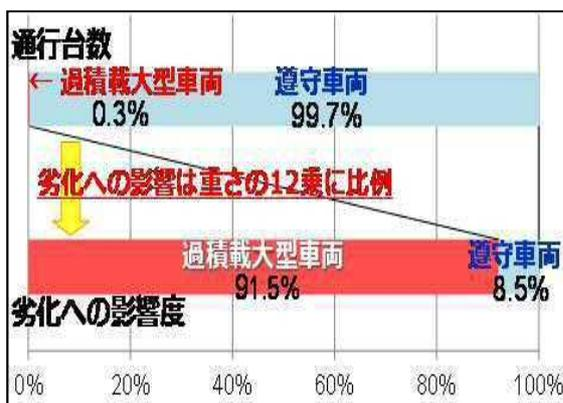
**0.3%の重量を違法に超過した大型車両※が道路橋の劣化に与える影響は全交通の約9割を占め、一部の違反車両が道路を劣化させる主要因となっている。**※車両総重量20tを超える違反車両
