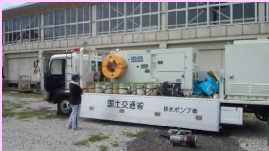
訓練に展示された排水ポンプ車
