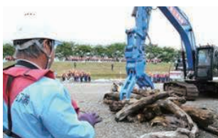
北陸技術事務所無人バック ホウによる倒木撤去
