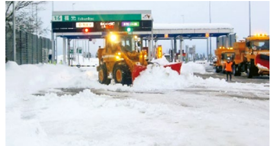
東海北陸自動車道の除雪支援を行う除雪ドーザ
