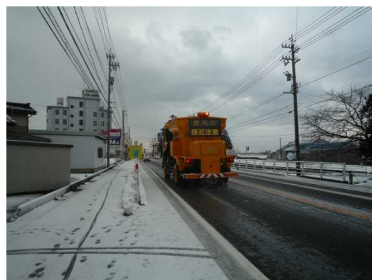
薬剤散布作業の様子
