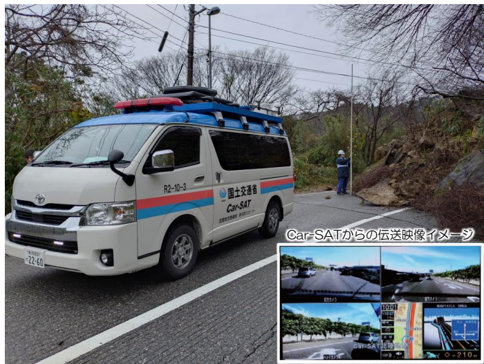
Car-SAT（移動型衛星通信設備）による 道路状況調査状況 （令和6年能登半島地震）
