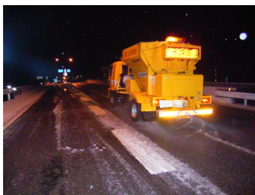
凍結防止剤散布の状況
