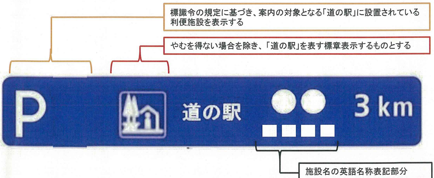
図2. 「サービス・エリア、道の駅及び距離」の標準的なレイアウト案2
