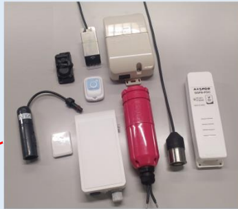
実証実験に用いている浸水センサ
