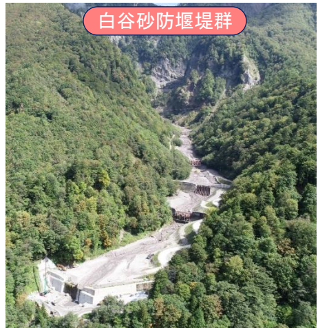
対策による効果(土砂・流木捕捉) 整備例
