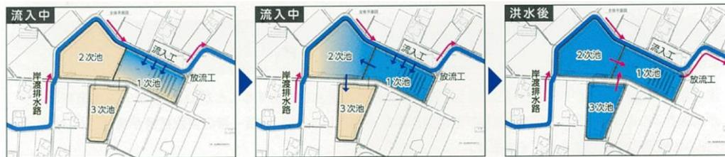
洪水調整池に貯留した水は、洪水が収束した後で、安全を確認しながら下流域へ排水する。
