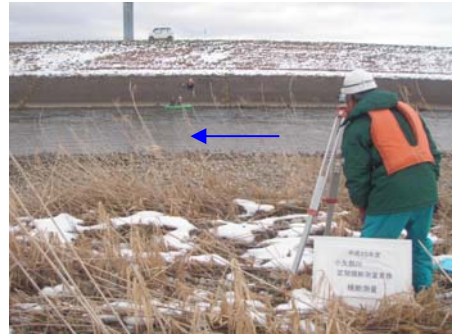
写真 5.3 定期横断測量
