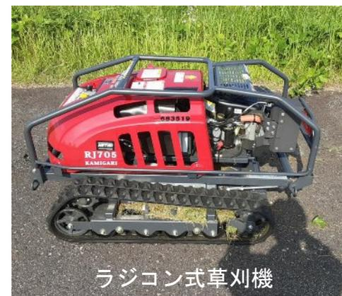
従来、堤防法面が急勾配の箇所は、肩掛け式（人力）で実施していましたが、急勾配で運用できるラジコン式草刈り機の導入により、作業効率及び作業員の安全性が向上しています。
