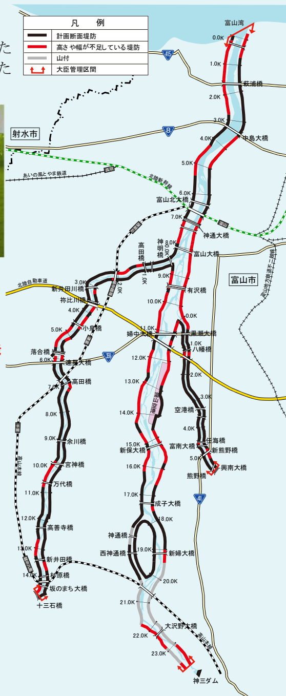
▲堤防の整備状況（H29.3時点）
