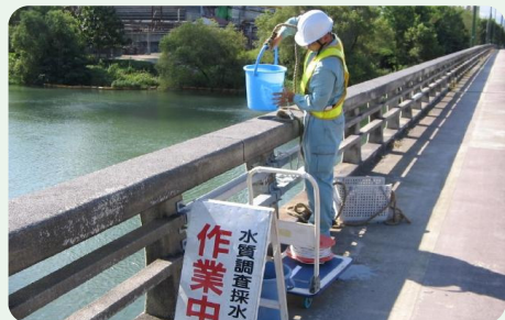
▲採水作業の状況
