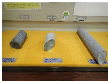
ボーリングコア
