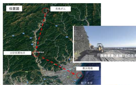
長島ダムの掘削土を駿河海岸の養浜に活用(静岡県)
