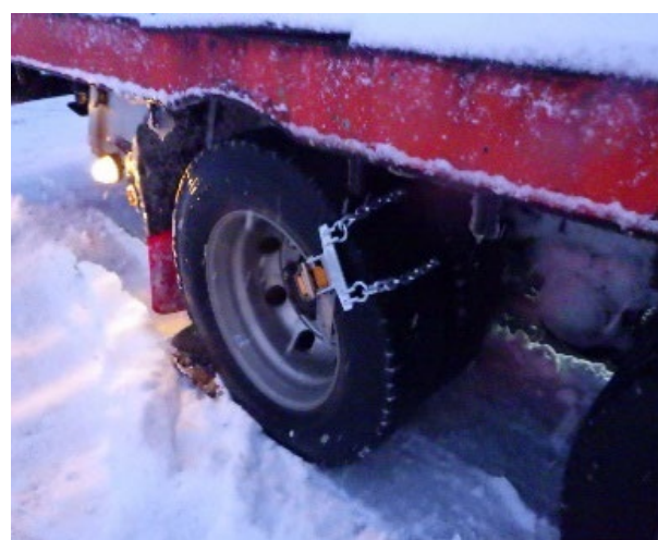
緊急脱出用具の装着状況
