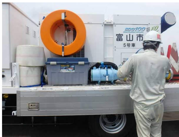
排水ポンプ車機材の確認
