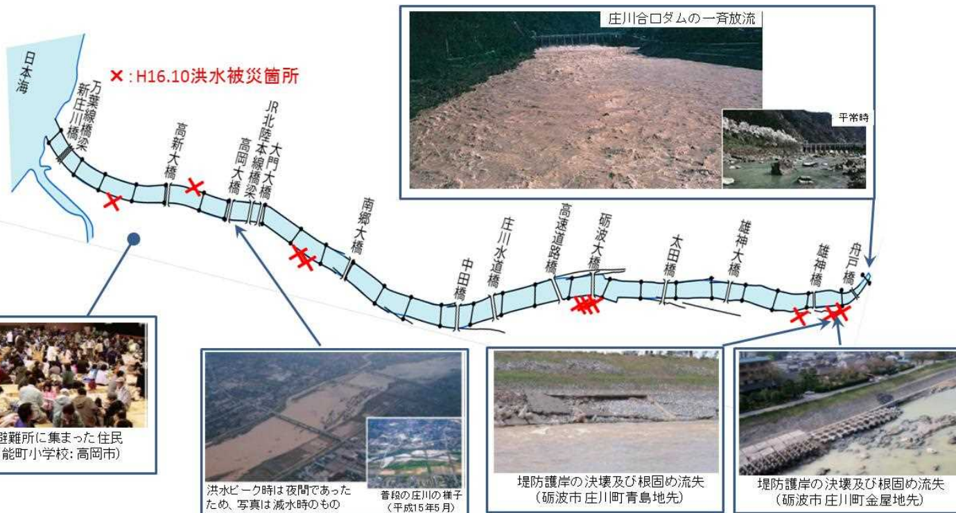
平成16年10月洪水での被害状況
