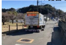
(空洞探査車による調査)
