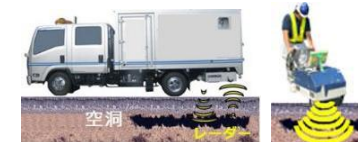
路面下空洞調査
