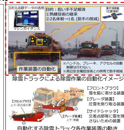
除雪作業の自動化
