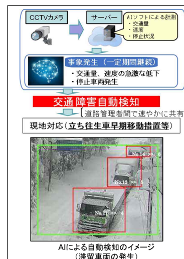
交通障害自動検知システム
