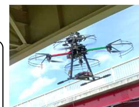
ドローンによる損傷把握
