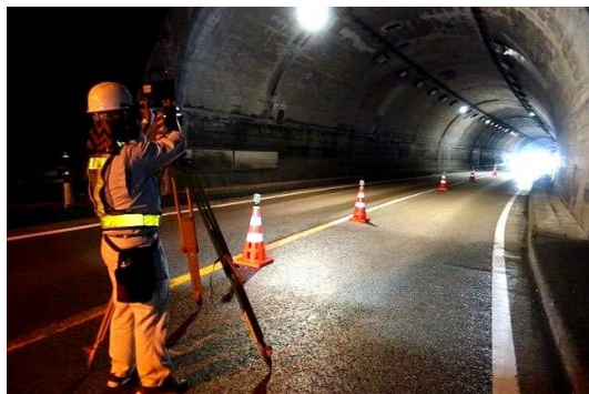
3次元レーザー計測作業状況
