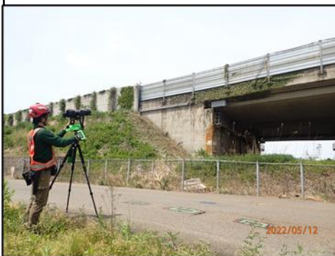
高解像度カメラによる撮影状況
