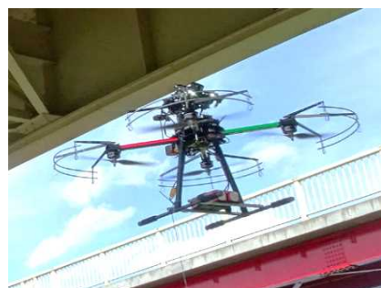
▲橋梁の損傷写真を撮影する技術
