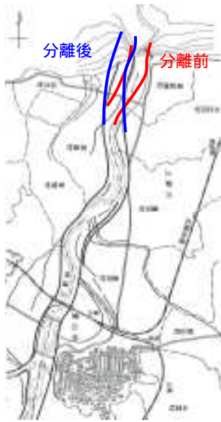
図 2.2 河口河道の付替(東岩瀬港改築工事)
