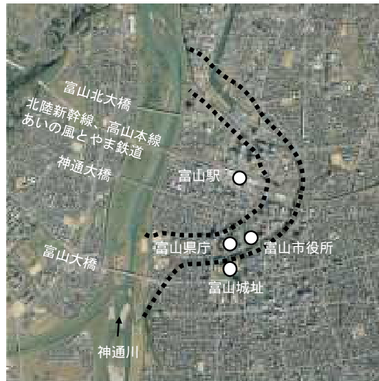
図 2.2 河口河道の付替(東岩瀬港改築工事)
