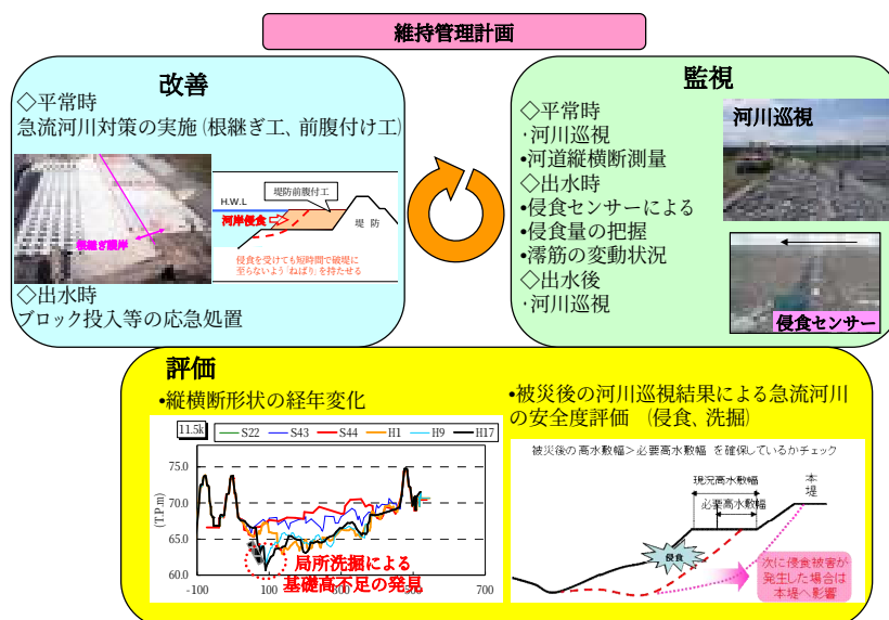
図 10.3 急流河川における河岸侵食対策のサイクルイメージ
