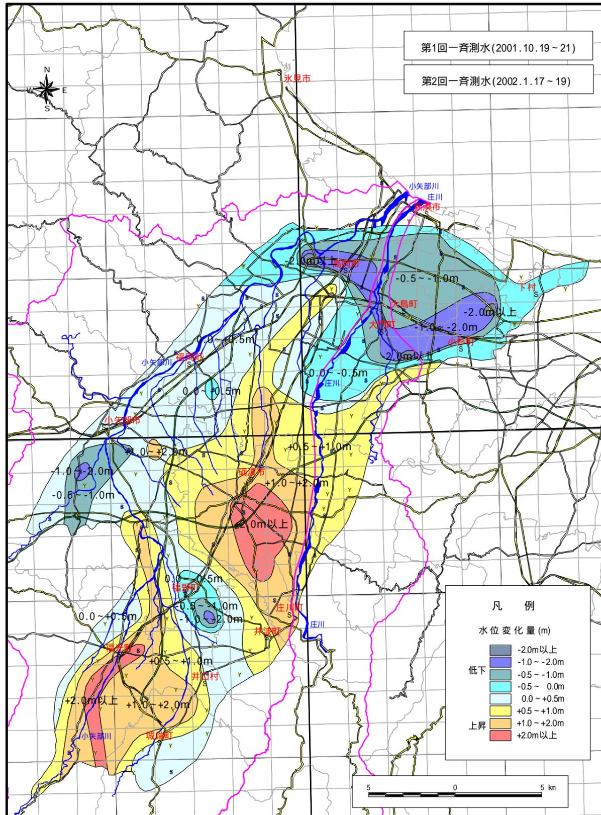
地下水水位変動量分布図（2001年10月から2002年1月の水位の変化）
