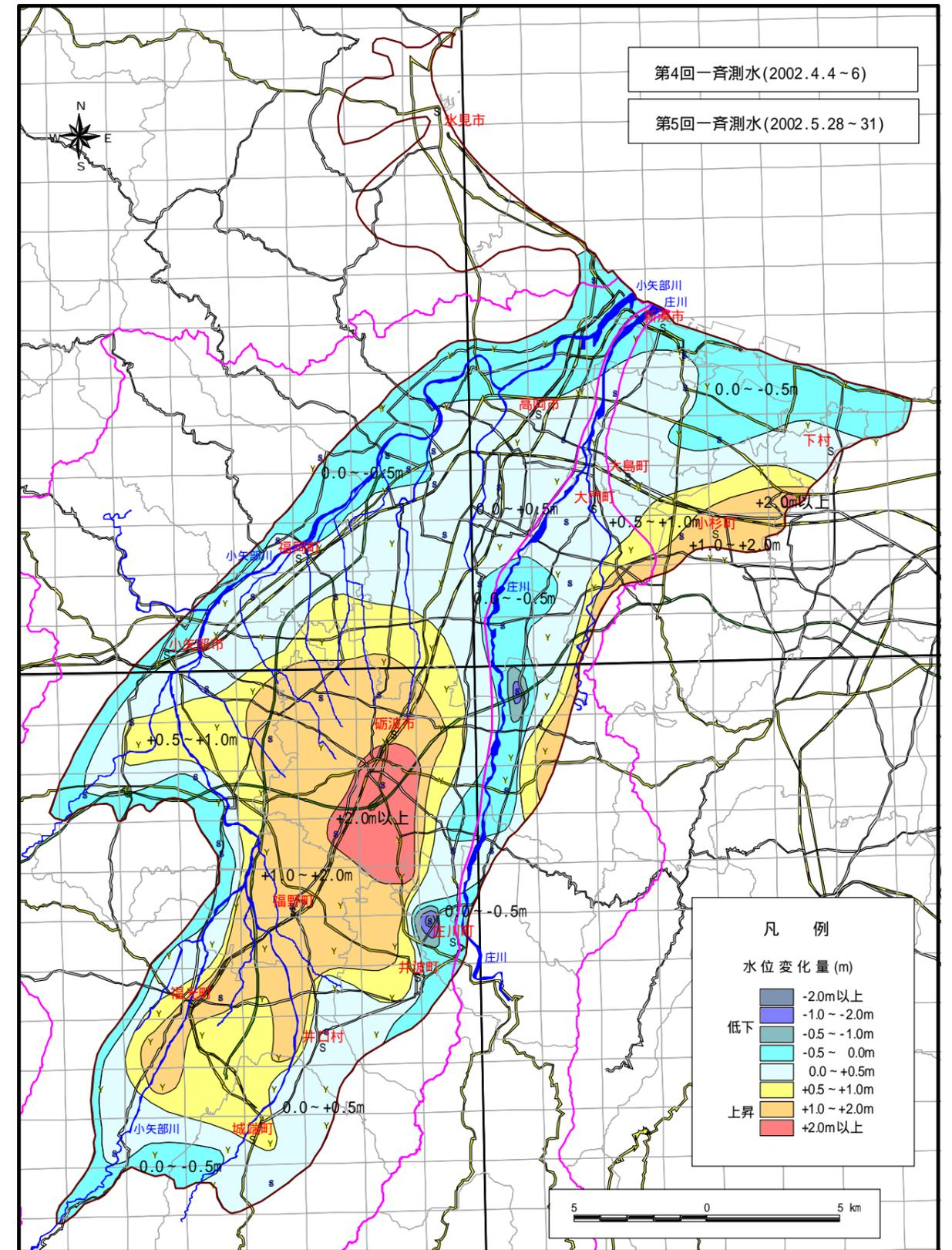
地下水水位変動量分布図(2002年4月から2002年4月の水位の変化)
