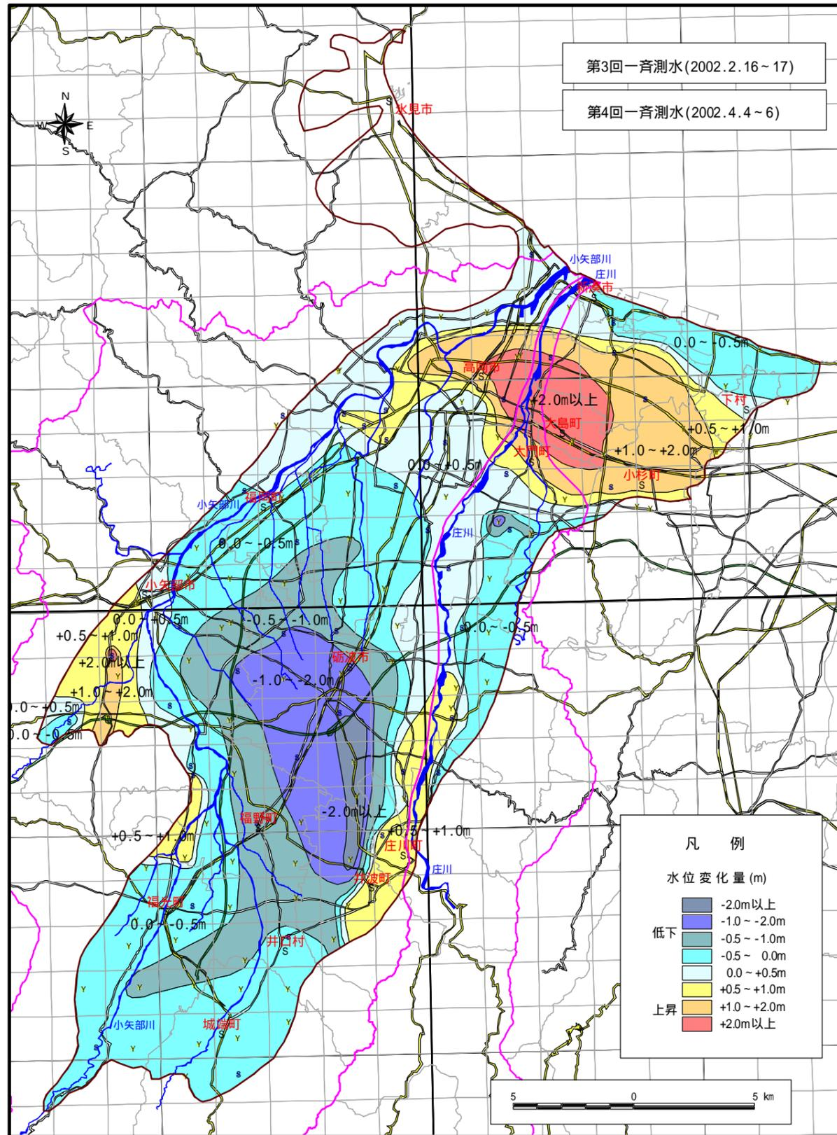
地下水水位変動量分布図(2002年2月から2002年4月の水位の変化)
