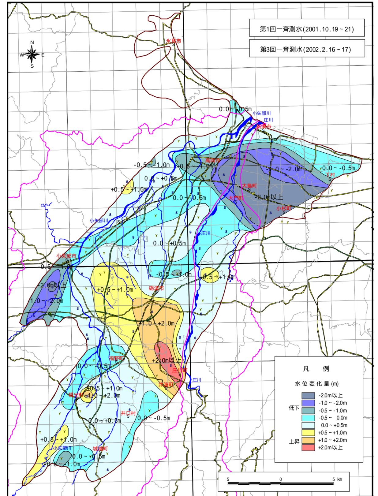
地下水水位変動量分布図（2001年10月から2002年2月の水位の変化）
