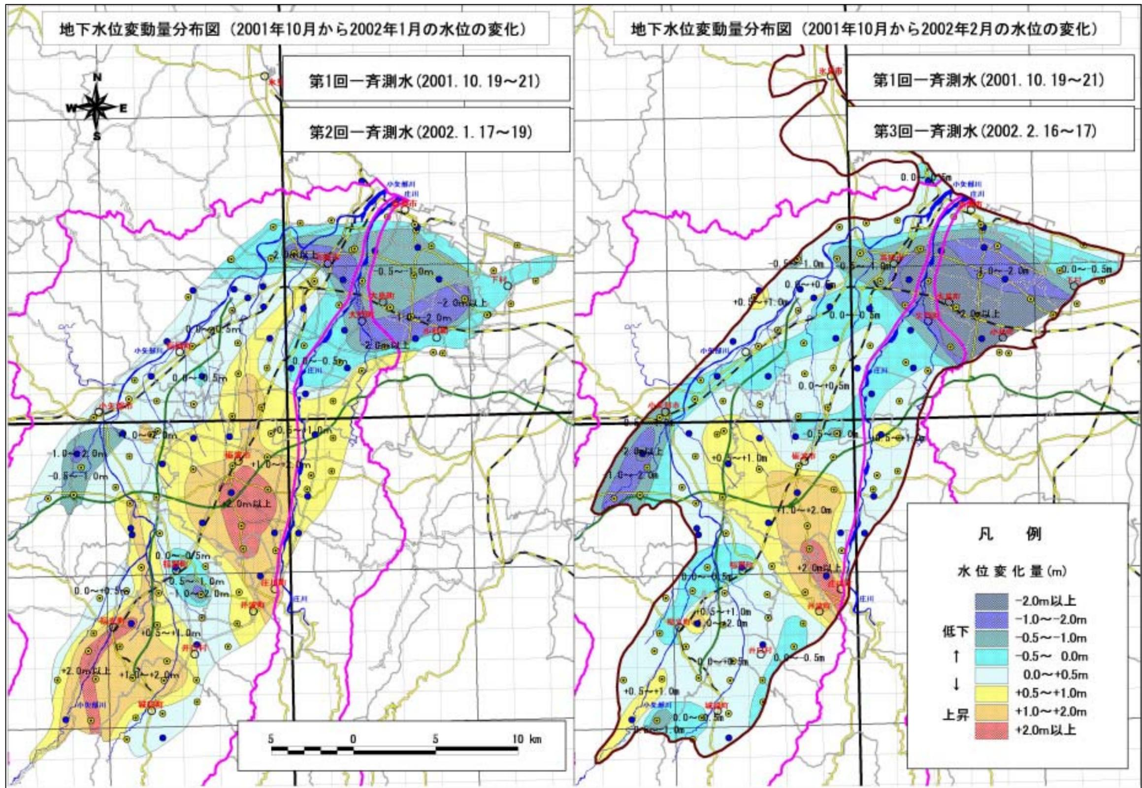
図 2-4-3 (1) 地下水水位変動量分布図
