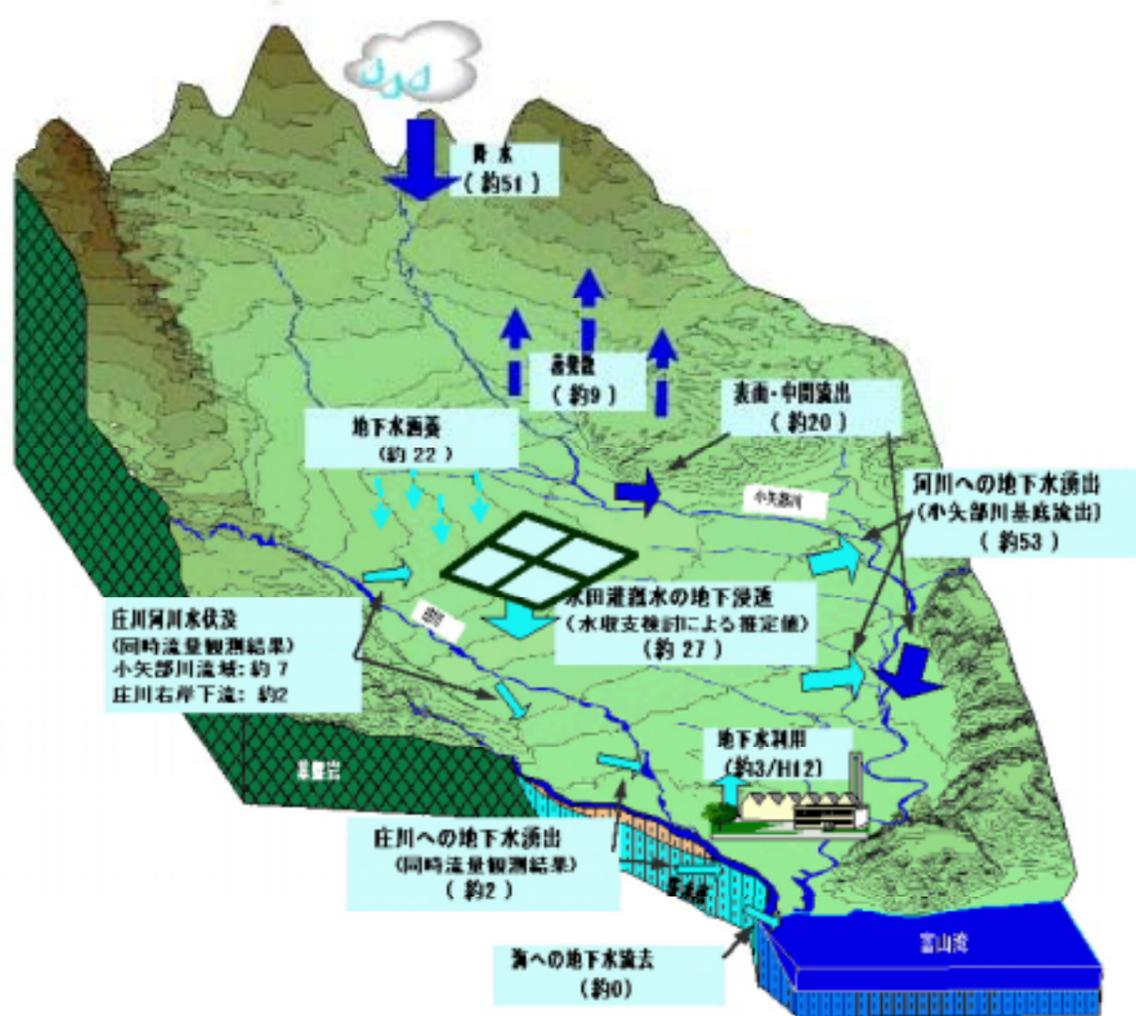
図 3 庄川・小矢部川流域全体の概略水収支 (単位:  $\text{m}^3/\text{sec}$ )
