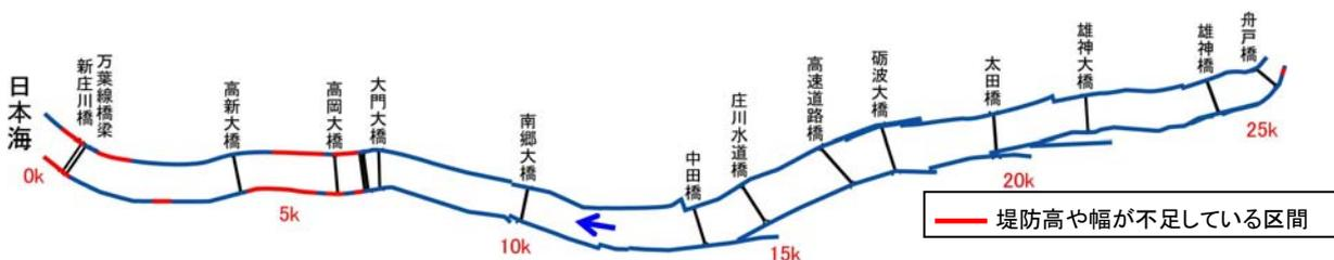
図 3-13 戦後最大洪水に対する堤防整備状況
