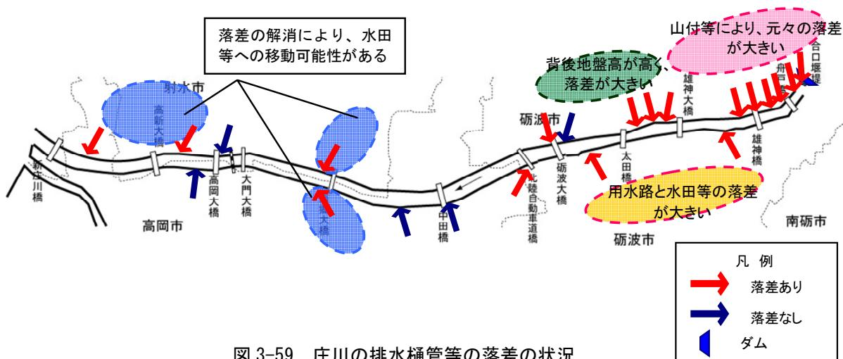
図3-59 庄川の排水樋管等の落差の状況
