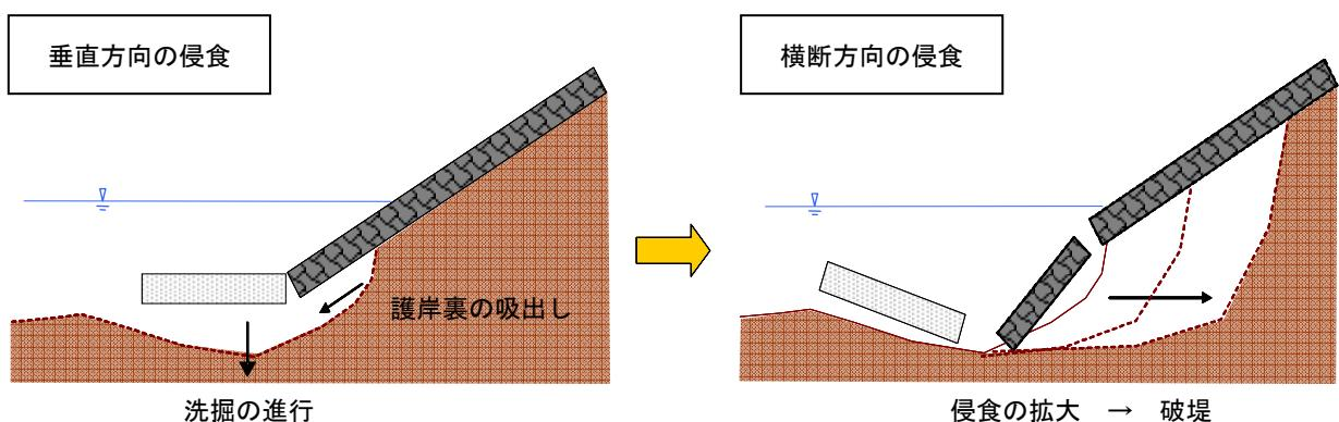
図 3-23 河岸侵食のメカニズム
