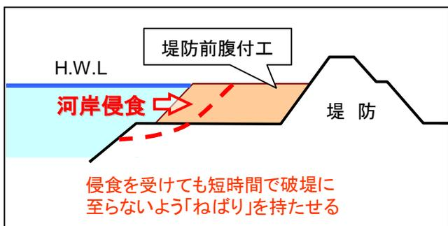
図 5.5 急流河川対策工 (前腹付けイメージ図)
