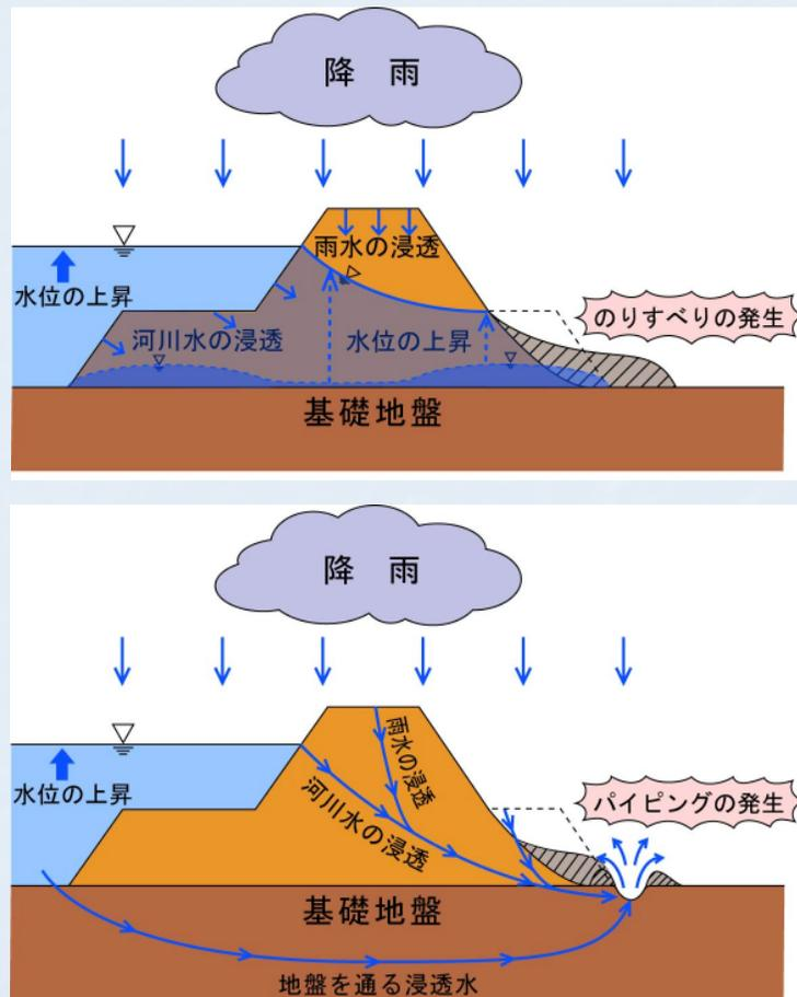
図. のりすべり及びパイピング破壊イメージ図
