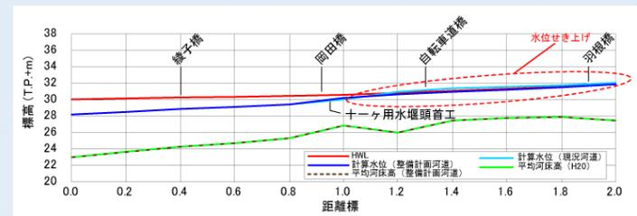
※渋江川では取水用の水位を確保するため、低水路幅を狭くしており、堰上流側に水位がせき上げられるため、河積を拡大して水位低下を図るとともに、管理者と調整し、十一ヶ用水堰頭首工を改修する。
