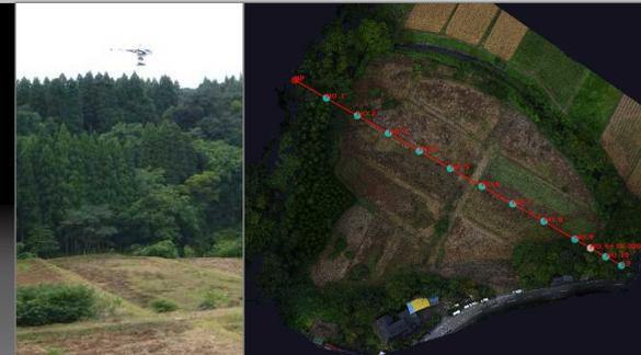
UAVを用いた空中写真測量
