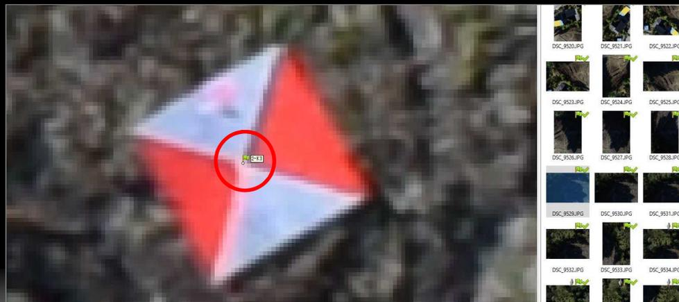
標定点の拡大画像。座標値を持つ標定点の中心にグラウンドコントロールポイント（画像処理を行う上での基準）を持たせる。
