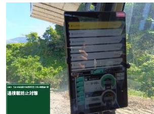
過積載防止対策『ペイロード機能搭載型バックホウ』による積込作業
