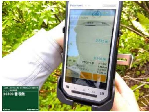
RTK-GNSSとIMUによるチルト補正観測（NETIS登録番号：KK-240102-A）
