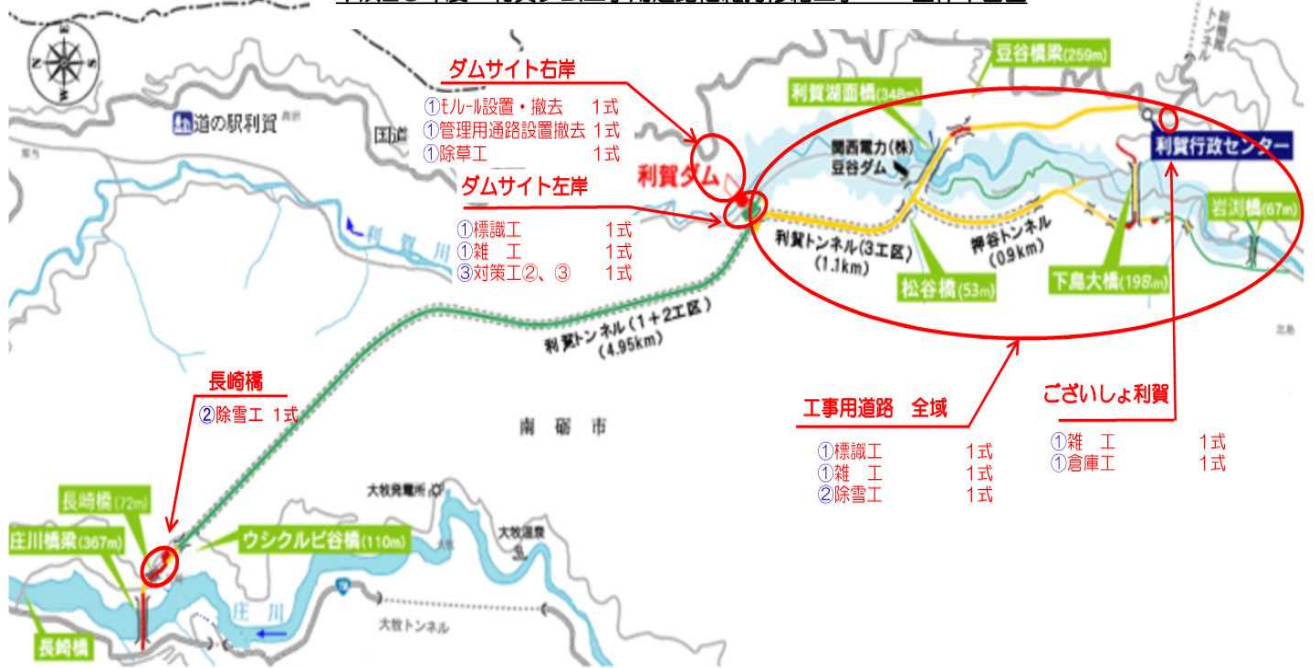
平成28年度 利賀ダム工事用道路他維持修繕工事 全体平面図
