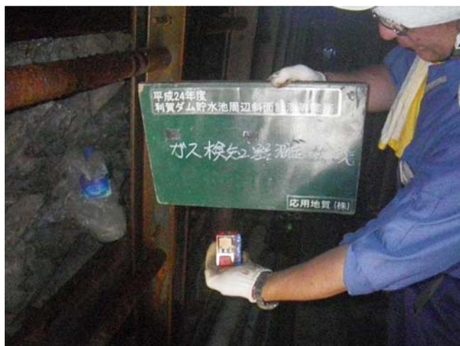
写真6. 横坑内でのガス濃度確認の様子
