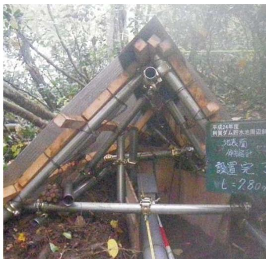
写真8. 地盤伸縮計への積雪対策
