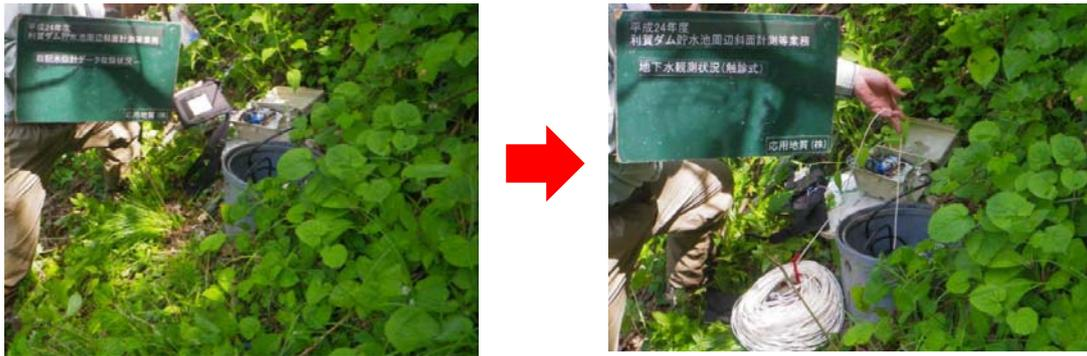
写真9. 自記水位計観測(左)と手計りによるクロスチェック(右)
