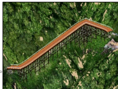
仮栈橋の3次元モデルデータ
