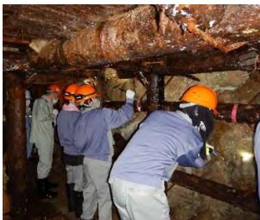
横坑観察でハンマーで坑壁(ダム建設地の岩盤)を調査
