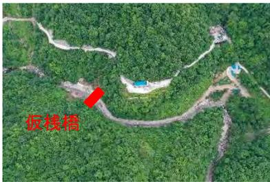
工事用道路はトンネル坑口出口まで到達しており、現在トンネル出口のヤードを造成中
