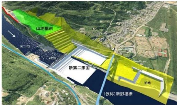
大河津分水路改修事業では3次元データを用いて、山地掘削、第二床固、(仮称)新野積橋の統合CIMモデルを作成し、常に最新の状態に保つことで輻輳する現場の状況を的確に把握でき、建設現場の安全性・生産性向上が図られる。これにより工事が円滑に進むことで越後平野の治水安全度の向上が期待される。
