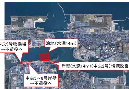
伏木富山港新湊地区では、船舶の大型化、取扱貨物の増加に対応するため、中央2号岸壁の増深改良(水深14m化)を行うとともに、一部係留施設の廃止、貨物の集約、ふ頭用地の利用方法を見直すなど、ふ頭再編を図っている。
