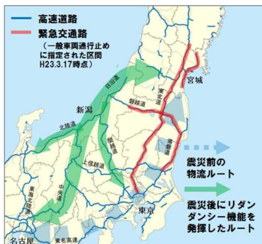
日本海側の幹線道路網が物資の輸送ルートとして機能 図 12 東日本大震災における道路の役割
