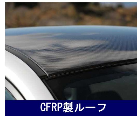
CFRP製ルーフ
