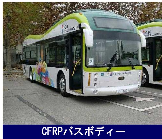
CFRPバスボディー
