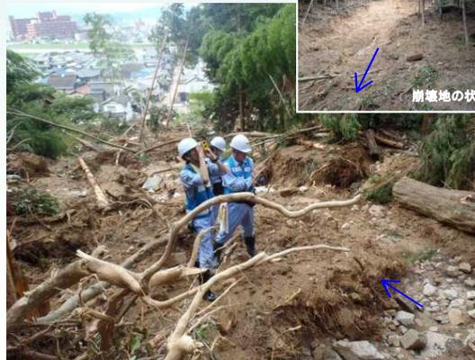
▲レーザー距離計による崩壊地計測
