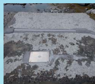
ハイドロフォン（※流れている土砂が当たった回数を数える計測器です。流れている土砂の量が分かります）
